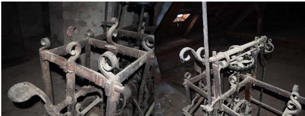
12–13. kép. Az Aszalai István által készített toronyóra pántvasainak mives kivitelezése és orsójáratú gátszerkezete.
