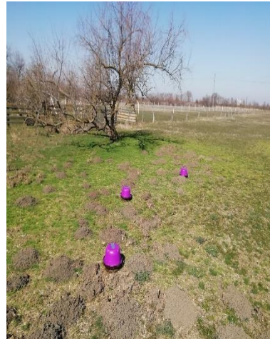
1. ábra: A szén-dioxid-kibocsátás méréséhez használt keretek és edények
