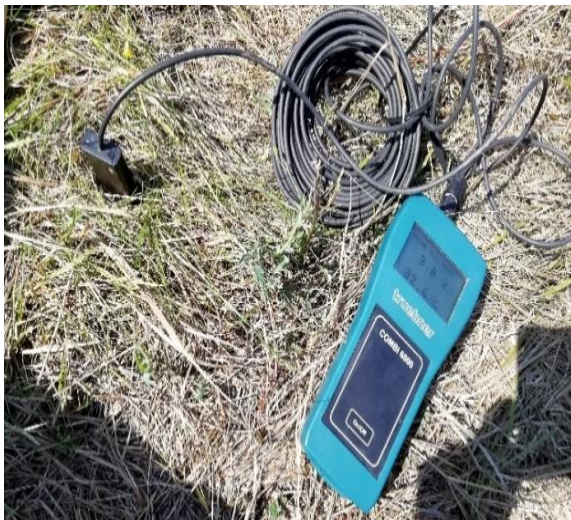
2. ábra: SMT-100 műszer a talajhőmérséklet és talajnedvesség méréséhez
