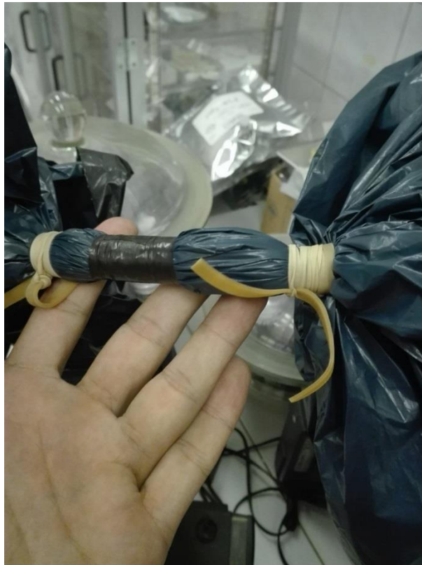
6. ábra: A mintagáz tartó zsák csapszigetelése.
