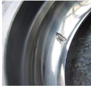
12. ábra. Sérülés a csapágy külső gyűrűjén
