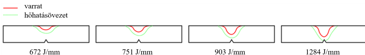
1. ábra: Az ütőpróbatestek bemetszéseinek helyei
