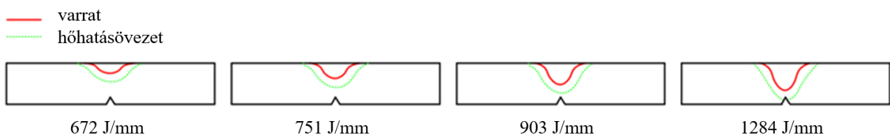
1. ábra: Az ütőpróbatestek bemetszéseinek helyei
